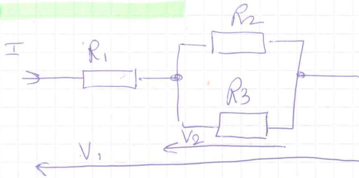
1.  $R_{eq} = \frac{R_2 \times R_3}{R_2 + R_3} = \frac{1,2 \times 3,3}{1,2 + 3,3}$
